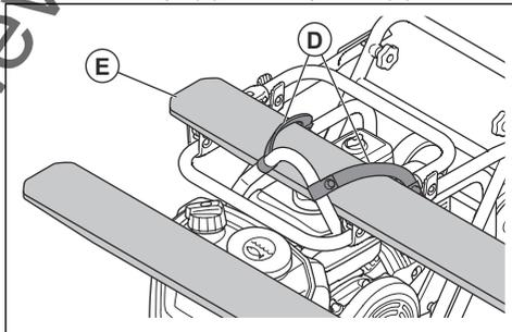
**Забележка:** Ремъците са стандартно оборудване при модел LF 130, но опционално при модели LF 75, LF 80, LF 100
